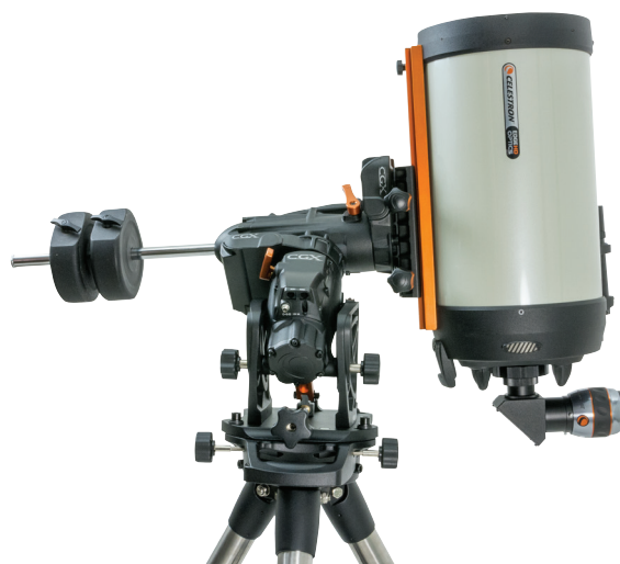
Figure 6 Équilibrage de la monture
