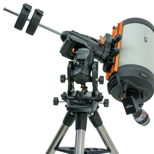
Figura 9.1 Un lato del limite meccanico di AR
