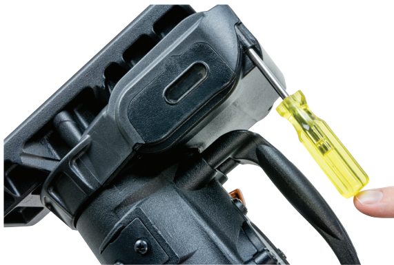
Abbildung 12 Entfernen der Getriebeabdeckung
