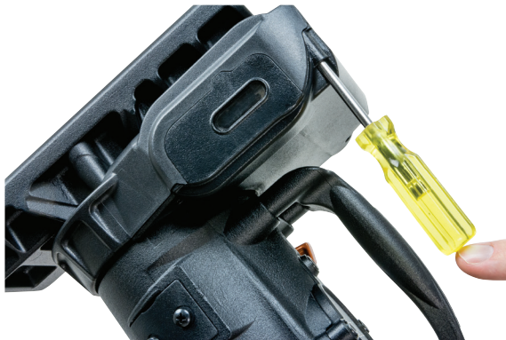
Figura 12 Retirar la tapa del engranaje
