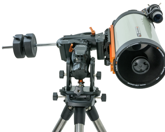
Figura 9.2 Un lato del limite meccanico di DEC
