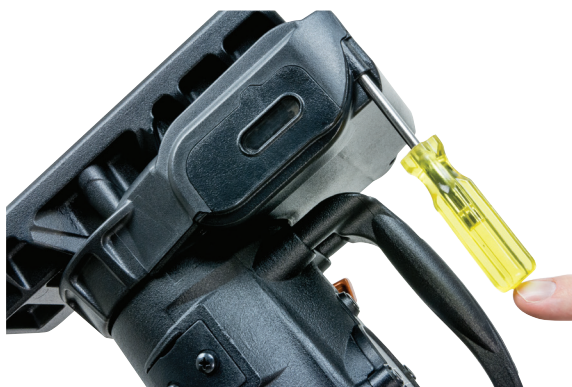
Figure 12 Retirer le cache d'engrenage
