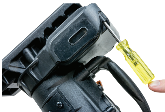
Figura 12 Rimozione della copertura della vite
