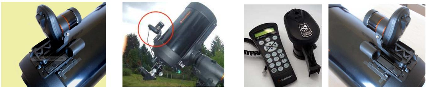
Das Geheimnis der StarSense-Technik ist ein kleines Kameramodul welches wie ein Sucher auf das Teleskop aufgesetzt wird. Es nimmt 3 Weitwinkelfotos von verschiedenen Bereichen des Sternenhimmels auf, der StarSense-Handcontroller analysiert diese Fotos und berechnet daraus die Position der anderen Objekte des Sternenhimmels. Diese „plate solving“ genannte professionelle Technik hat Celestron hiermit erstmals zu einem erschwinglichen Preis für Amateurastronomen auf den Markt gebracht.
