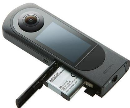
Zum ersten Mal in der RICOH THETA-Serie wird die neue RICOH THETA X von einem austauschbaren Akku (DB-110, auch separat erhältlich) betrieben. Und die Speicherkapazität kann durch die Verwendung einer externen Speicherkarte (microSDXC) erweitert werden. Selbst bei stundenlangen Aufnahmen oder der Aufnahme vieler Bilder können Benutzer weiter fotografieren, ohne sich Gedanken über den verbleibenden Akkuladestand oder die Speicherkapazität machen zu müssen.
