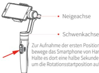
Zur Aufnahme der ersten Position (Rotationsstartposition) bewege das Smartphone von Hand an die gewünschte Position. Halte es dort eine halbe Sekunde lang. Drücke die Funktionstaste, um die Rotationsstartposition aufzuzeichnen.
